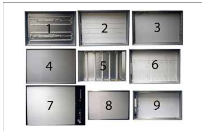
Erilaisia valomainos laatikoita, joilla on erilainen SPD, valittiin taustavalon tuottamiseksi käyttämällä erilaisia valotekniikoita: loisteputki (LK 1 ja 5), reunavalaistu (LK 3, 7, 8 sekä 9 hajottimella) ja taustavalaistu (LK 2, 4 ja 6).
